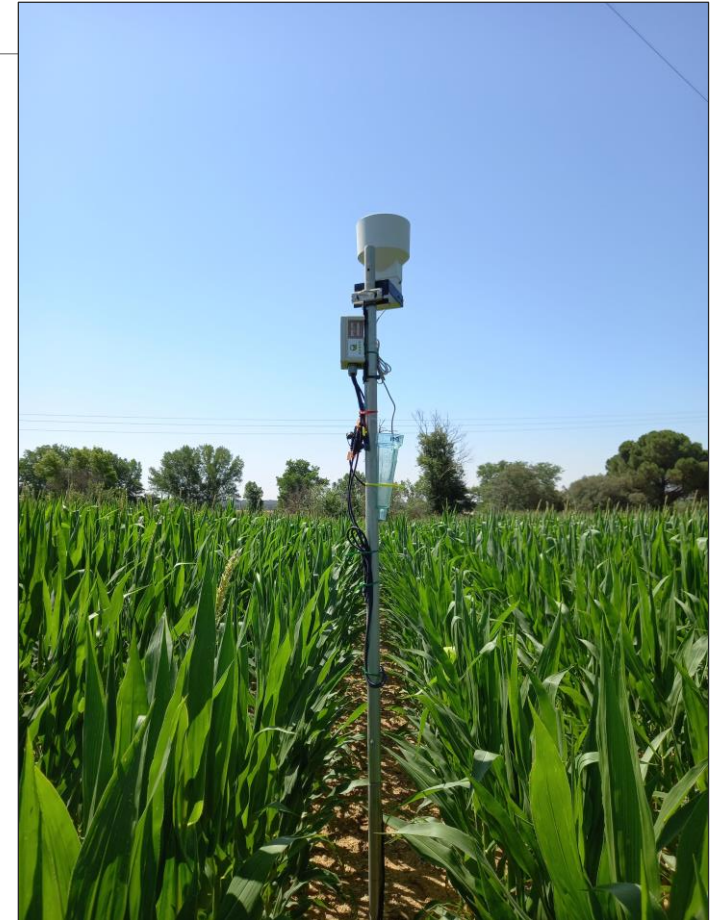
Nodo equipado con pluviómetro y sondas de humedad
