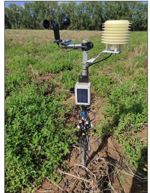
Nodo equipado con pluviómetro, sondas de humedad, anemómetro y unidad H y T
