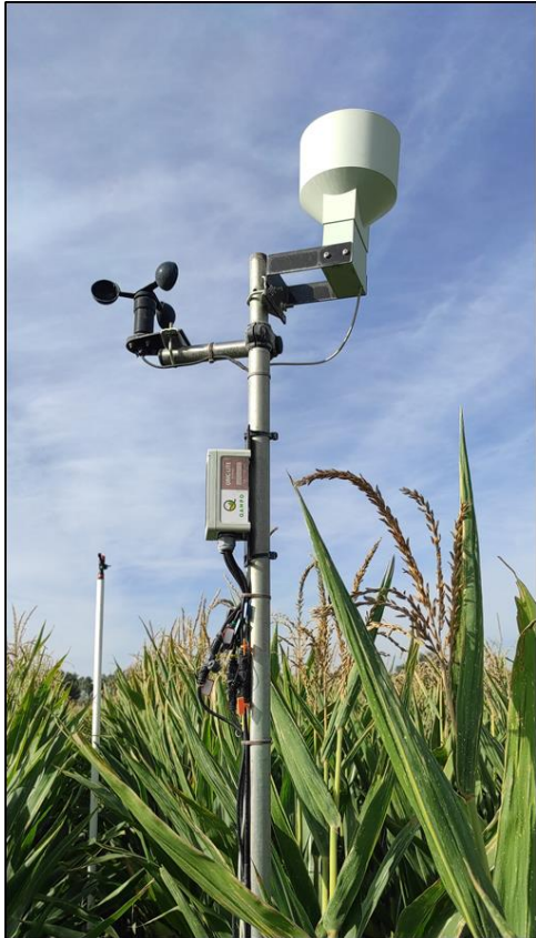
Nodo equipado con pluviómetro, sondas de humedad y anemómetro
