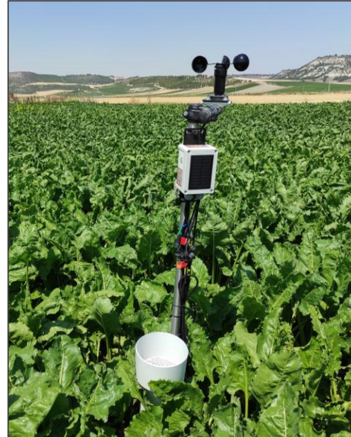
Nodo equipado con pluviómetro, sondas de humedad y anemómetro
