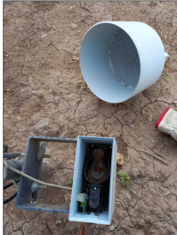
Pluviómetro anclado al mástil del nodo.
